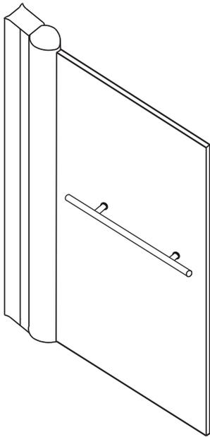
**A** Fijar el perfil de la mampara a la pared, alineando a 10 mm. del borde exterior de la bañera
